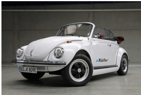
Der e-Käfer - aufgebaut mit E-Komponenten aus dem neuen e-up!
